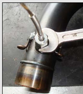
**Attenzione:** nel far correre il cavo della termocoppia lungo il telaio tenetelo il più lontano possibile da altri cavi (come il cavo RPM o quello del ricevitore di giro) per minimizzarne le eventuali interferenze.
